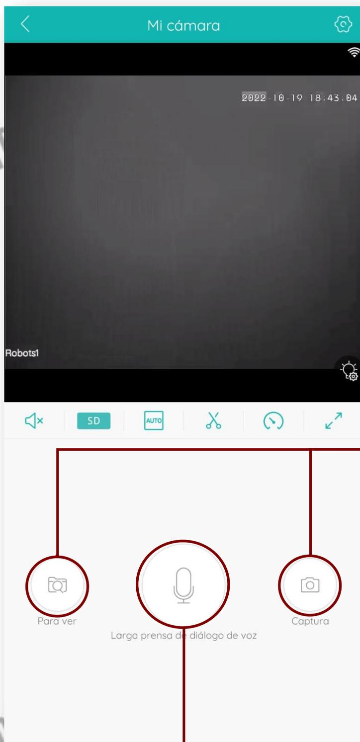
Las funciones Playback (Para ver) y Snapshot (Captura) únicamente funcionan si se ha insertado previamente una memoria micro SD en la cámara.
